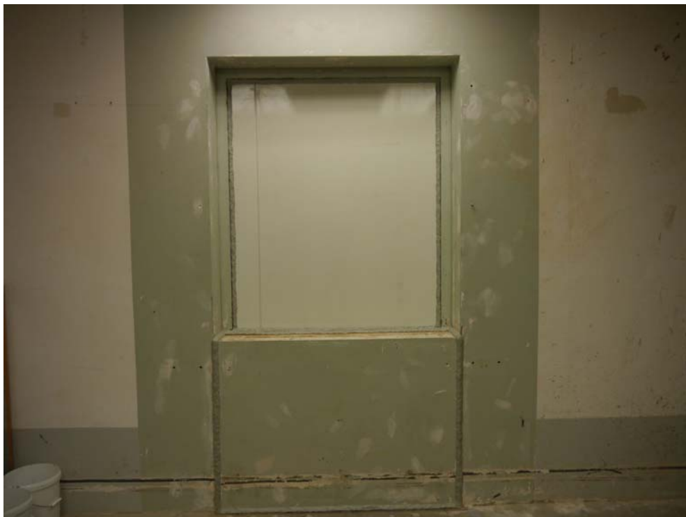
Abbildung B.2. Prüfaufbau im Fensterprüfstand: senderraumseitige Ansicht.
