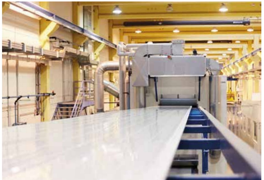
Kontinuierliche Sandwichfertigung mit den modernsten und größten Doppelbandanlagen der Welt
