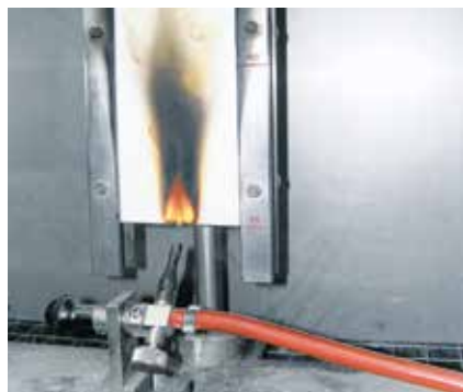
Qualitätsprüfungen über den gesamten Fertigungsfluss: Brandprüfung
