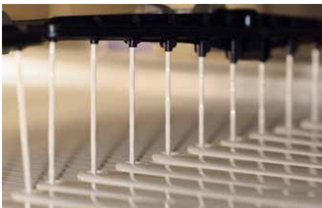
Gleichbleibende Hartschaumqualität über den gesamten Querschnitt des Paneels
